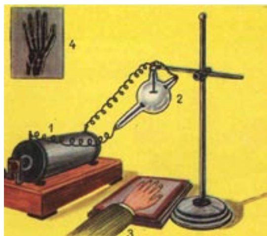
1. Ruhmkorff. 2. Crookes buis. 3. hand op fotografische plaat. 4. RX foto. (Uit 'Zoek het eens op' B.A.G.E.)
