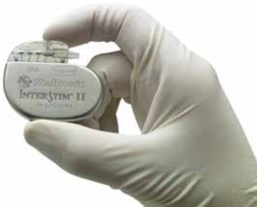
Fig. 1. De Interstim II sacrale neurostimulator die onderhuids geplaatst wordt voor de definitieve stimulatie.
