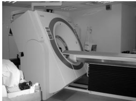
De gantry kan onder een hoek van +- 25 graden in beide richtingen geïnclineerd worden
