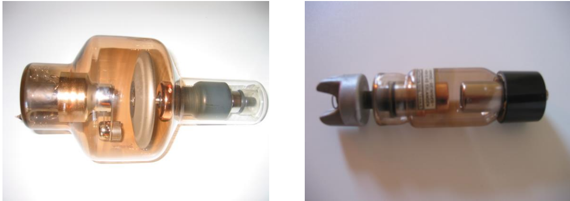
Fig. 7. Röntgen buizen, links met draaiende anode, rechts met vaste anode.
