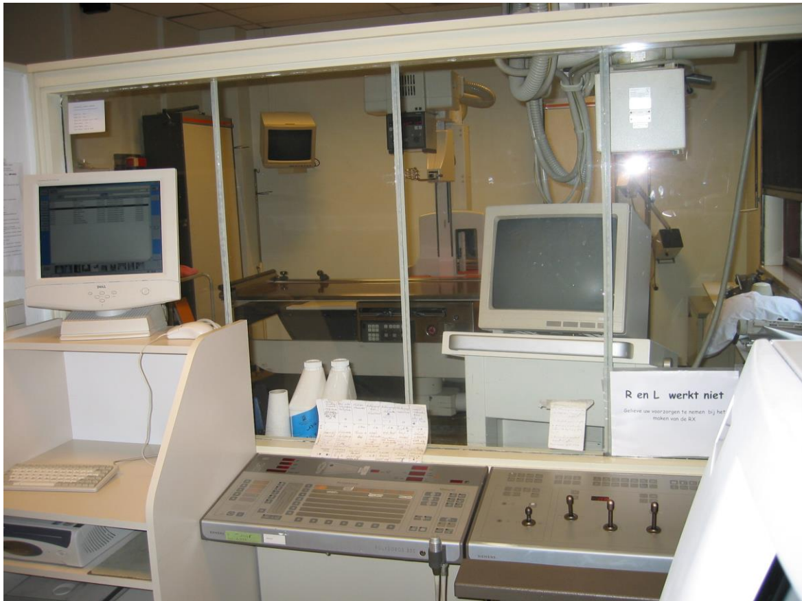
Fig. 5 beeld van röntgenstatief met tafel, bedienings paneel en generator.
