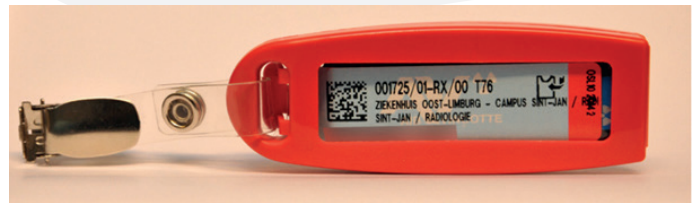
Figuur 2: Dosimeter te dragen OP de loodschort. De dosimeter heeft de letter T (Thyroid)
