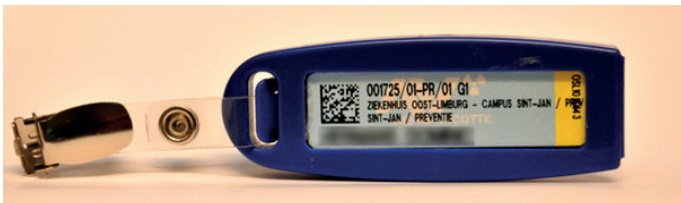
Figuur 1: Dosimeter te dragen onder de loodschort. De dosimeter heeft de letter G (global)
